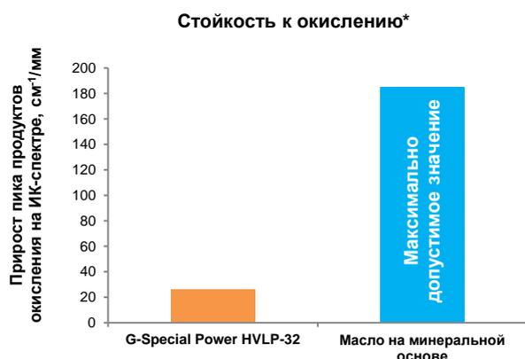
Отличная стабильность против окисления масла G-Special Power HVLP-32 обеспечивает сохранение уровня эксплуатационных свойств и защиту от лаковых отложений в гидросистеме на протяжении всего интервала замены.
