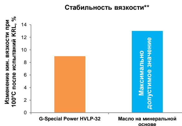
Высокая стабильность вязкости масла G-Special Power HVLP-32 позволяет ему сохранять необходимый уровень вязкости и производительности гидронасоса при высоких механических нагрузках на гидросистему в течение всего периода использования.
